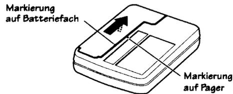
Legen Sie die Batterie in das Batteriefach ein und beachten Sie dabei die im Fach angezeigte Polarität.
