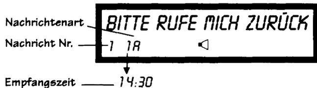
Unten links in der Anzeige wird die Art der Nachricht angezeigt. Nach einer Sekunde wechselt diese Anzeige. Sie erhalten dann die Anzeige der Empfangszeit dieser Nachricht.
